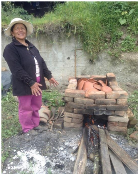
Horno de tipo abierto sin juntas entre los ladrillos, poco eficiente, permite escape de calor y un cocido desigual en la cerámica, lo que representa más horas de trabajo y madera para alcanzar la temperatura ideal para la quema de las piezas.
