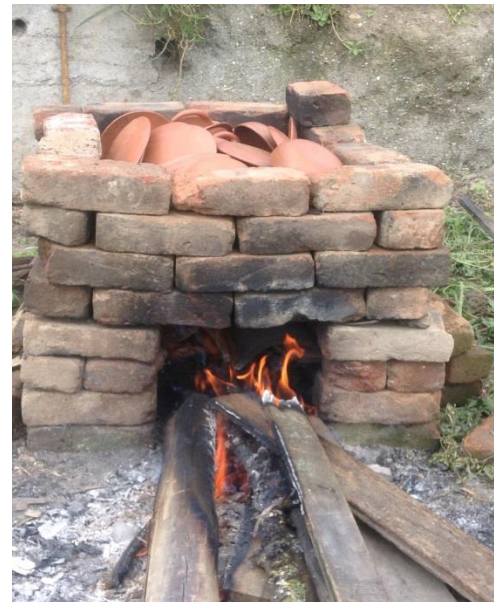
Horno de tipo abierto sin juntas entre los ladrillos, poco eficiente, permite escape de calor y un cocido desigual en la cerámica, lo que representa más horas de trabajo y madera para alcanzar la temperatura ideal para la quema de las piezas.
