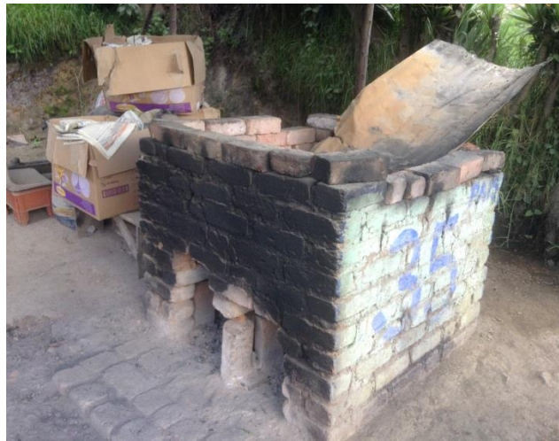
Horno de tipo abierto, la lata que se muestra en la imagen sirve para cubrir la cerámica a quemar.
